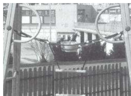
Sítí neprošel zkušební prostředek, hrozí nebezpečí zachycení hlavy dítěte
