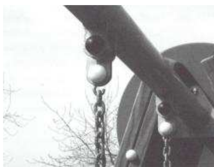
Nevyhovující použití esíčka pro zavěšení (při zátěži se rozevírá)
